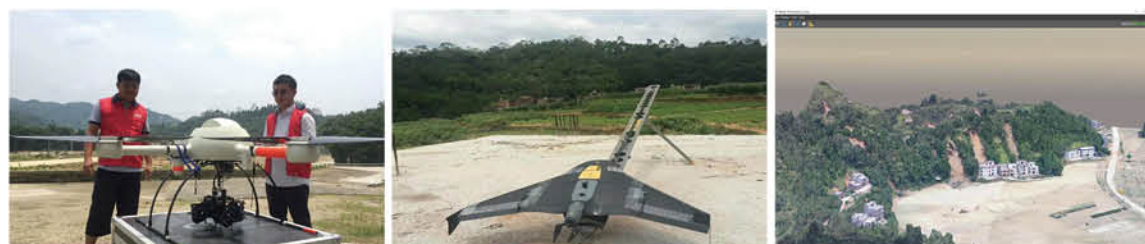
长续航多轴无人机倾斜摄影平台 航拍使用的高速固定翼无人机系统 受灾区域倾斜航空摄影三维立体图
